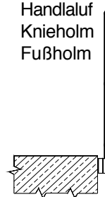
Seitliche Befestigung mit „Geländerschuh“
